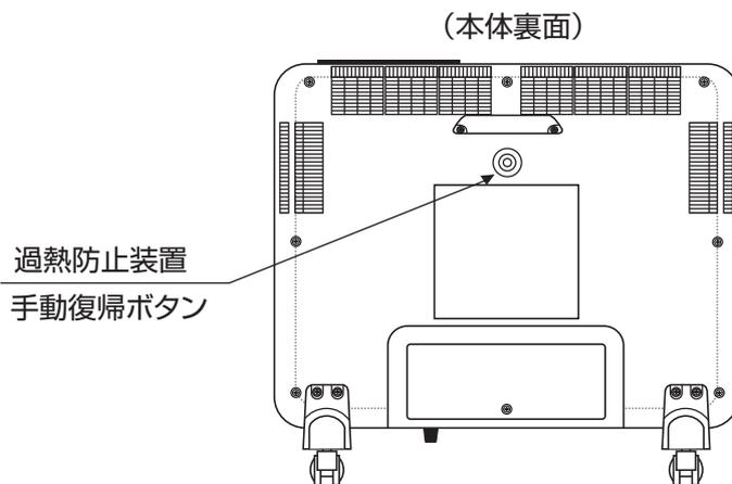
1. 過熱防止装置が働いたときには、**電源入切** を押して暖房器の電源を切り、電源プラグをコンセントから抜いて、異常の原因を取り除いてください。
